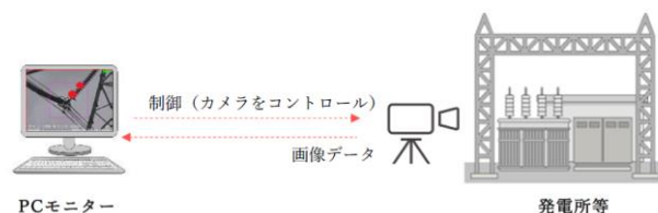
Fig. 3. 放電可視化監視システム
